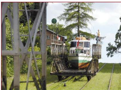
Angetrieben durch Wasserkraft werden große Mühlräder in Kraft gesetzt, die über Umlenkrollen die im Wasser befindlichen Boote gegenläufig über den Berg helfen.
